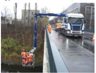
17,50m Reichweite: 20,90m max. Absenktiefe: 5,20m horizontaler Übergriff max.: vertikaler Übergriff max: Länge: Breite: 5,40m 11,50m 2,55m 4,00m Höhe: 32t Gewicht: 280kg max. Korbbelastung:
